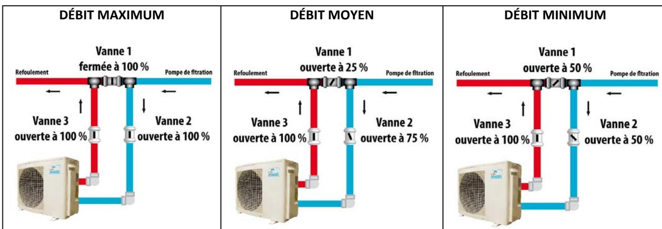
Pour un **fonctionnement optimal** de votre pompe à chaleur et minimiser le givre sur l'échangeur, régler le débit d'eau en fermant progressivement les vannes 1 et 2, pour **obtenir 1 à 2 degrés de différence** entre la température d'entrée (Temp IN) et la température de sortie d'eau (Temp OUT) comme sur l'écran ci-dessous.
