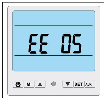
Cause : Trop grande différence de température entre l'entrée et la sortie d'eau
