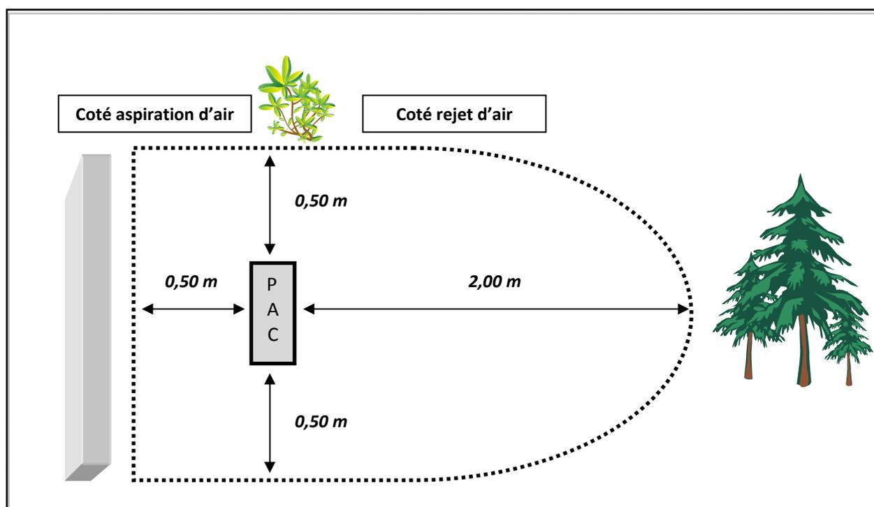
Ne pas installer la pompe sans un endroit confiné. Le ventilateur recyclerait le même air et les performances de la pompe s'en trouveraient dégradées.
